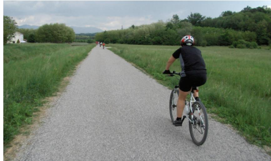
fig. 141: Percorso ciclopedonale a doppio senso ciclabile in contesto naturalistico (larghezza = 2,50 m + incremento adeguato, di norma tot. min 3 m)
