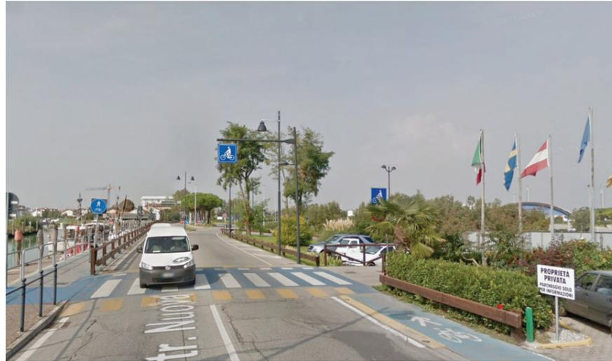
fig. 96: Attraversamento ciclopedonale con segnaletica verticale incompleta in strada Nuova a Caorle
