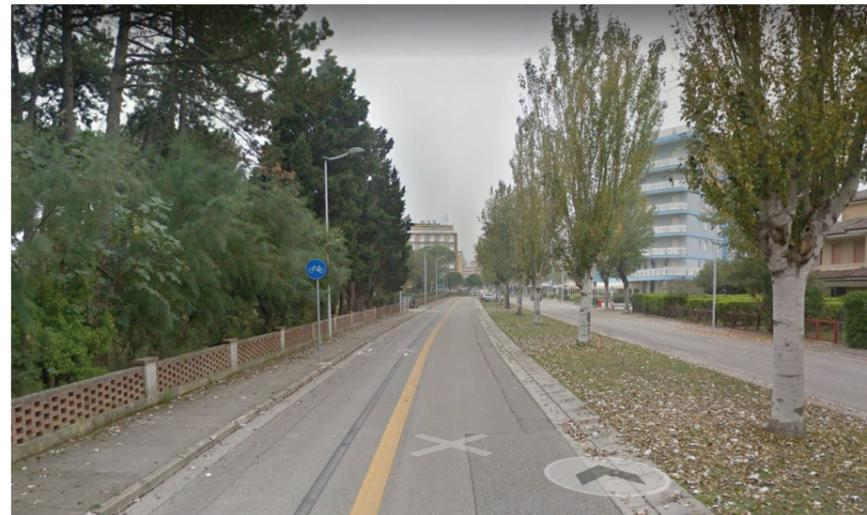
fig. 91: Pista ciclabile bidirezionale con segnaletica verticale errata ed orizzontale incompleta e priva di separazione fisica dalla sede carrabile in viale Lepanto a Porto S. Margherita
