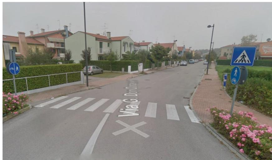
fig. 101: Percorso ciclopedonale interrotto da attraversamento solo pedonale in via don Dossetti inc. con via Sansonessa a Caorle
