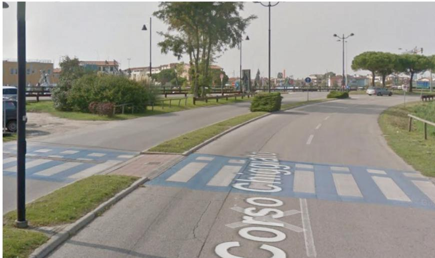
fig. 108: Attraversamento ciclopedonale con superficie in asfalto colorato in azzurro in corso Chiggiato a Caorle
