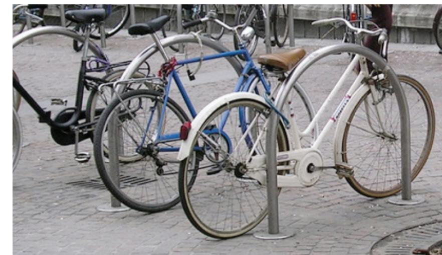
fig. 133: Portabici ad archetto: qui il telaio è facilmente legabile al supporto
