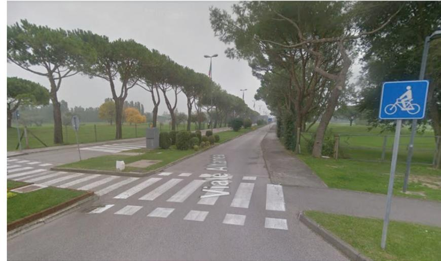
fig. 99: Attraversamento ciclopedonale con segnaletica orizzontale errata e verticale incompleta a Pra' delle Torri
